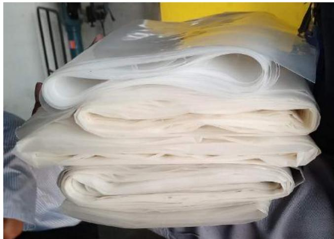
Gambar 3.4. Film plastik biodegradabel yang dibuat menggunakan mesin blown film
